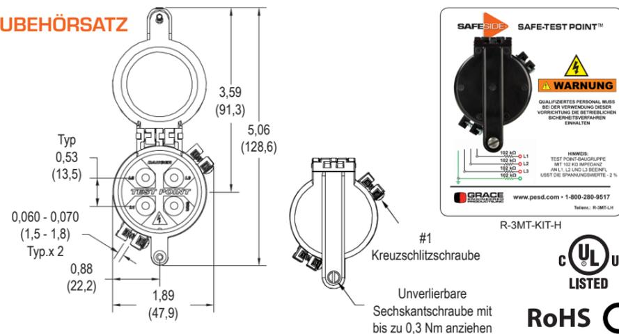
**KOMBINATION VON SPANNUNGSANZEIGE R-3W SERIE UND SAFE-TEST POINT™ – TECHNISCHE DATEN**
